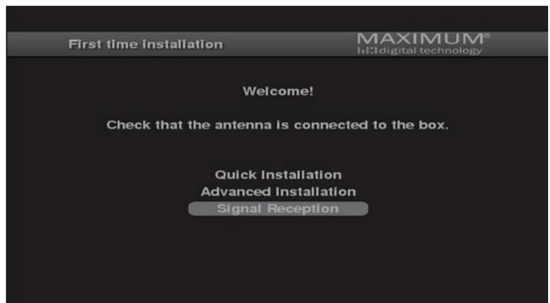
Om du inte får grön signal kan du prova en snabbinstallation. I så fall kommer Maximum T-541 VA att söka inom ett definierat frekvensområde för att hitta lämpliga kanaler.
