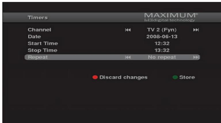
Gå igenom timerprogrammeringen och flytta nedåt med **P-**. När du är klar kan du spara dina alternativ genom att trycka **OK**. Du kan ta bort de val du gjort med knappen **<<**.
